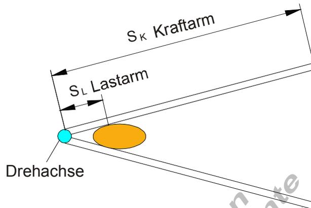
Der Nussknacker ist ein Beispiel für einen einseitigen Doppelhebel. Der Drehpunkt liegt am Ende der beiden Hebelstangen.
